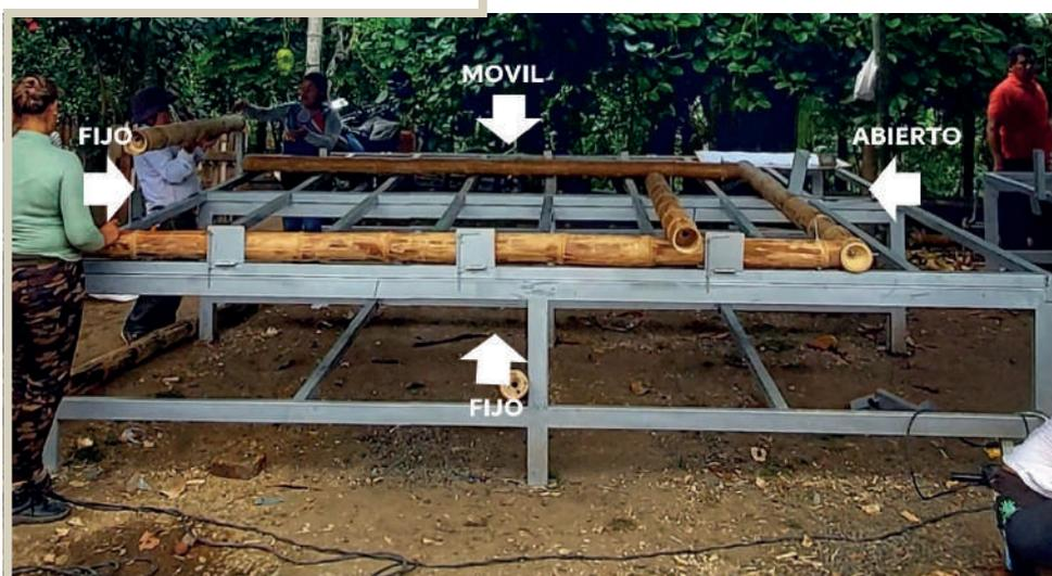
Fijador móvil en el sistema de molde ajustable.
